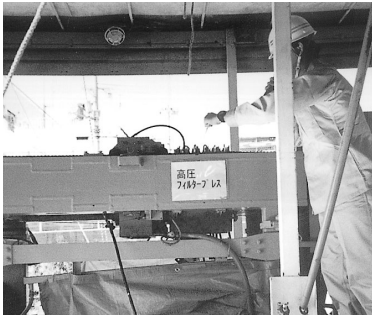
▲脱水固化装置の高圧フィルタープレス
